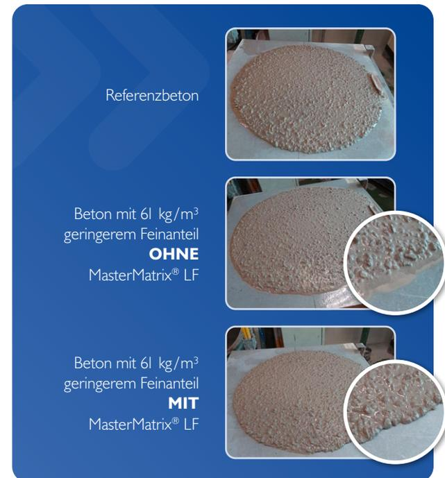
Der Beton mit geringem Feinanteil zeigt ohne MasterMatrix® LF Wasserabsonderungen, was auf Instabilität hinweist. Nach der Zugabe von MasterMatrix® LF tritt keine Wasserabsonderung mehr auf, und der Beton ist sehr homogen und stabil – vergleichbar mit dem Referenzbeton.
